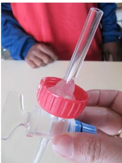
Colocamos el agua en un recipiente con llave de paso y medimos el tiempo que tarda en llenarse un recipiente de volumen conocido, una probeta.
