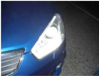
Las lámparas de xenón se componen de un tubo de vidrio lleno de sodio y de mercurio. El calentamiento del gas se traduce en una luz excepcional, pero el gas debe llevarse a una temperatura suficientemente alta. Para ello, se utiliza xenón que crea la chispa del encendido.
