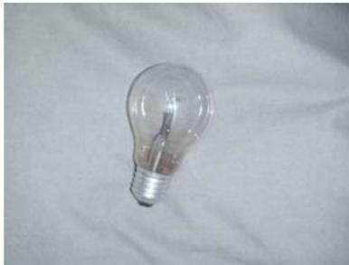
La bombilla es un recinto de vidrio ( arena de sílice ( $\text{SiO}_2$ ), carbonato de sodio ( $\text{Na}_2\text{CO}_3$ ) y caliza ( $\text{CaCO}_3$ ) que contiene un filamento de wolframio, se sostiene sobre un metal, normalmente iridio y en el interior hay un gas inerte argón, kriptón o nitrógeno.
