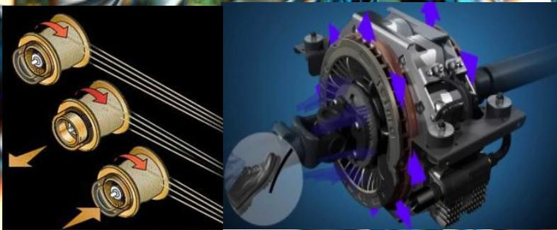
**Esto son ejemplos en lo que son usados el principio del freno magnético. Se usa en el mecanismo de los carretes de las cañas de pescar y en algunos motores de camiones de gran tonelaje.**
