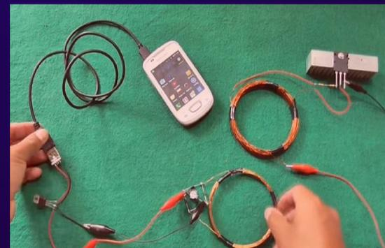
5. Por último, conectamos la bobina secundaria mediante el puente de diodos a un regulador, y este a la entrada USB la cual queda conectada con el móvil. Ya solo queda alejar y acercar una bobina a la otra para ver si funciona el proyecto
