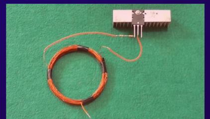
3. A continuación, juntamos una de las bobinas al transistor, y enchufamos este a la corriente eléctrica
