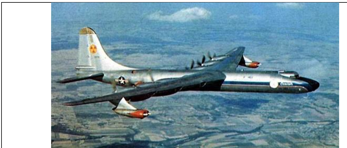
Fig. 11.-NB-36. Obsérvese el enorme tamaño del avión y los 10 motores, seis de pistón, con hélices propulsoras y 4 reactores. Véase como en la cola porta el logotipo de peligro de radiación nuclear.
