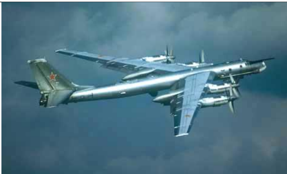
Fig. 13. Tu 95 Bear. Obsérvense los poderosos turbohélices que impulsan sendos pares de hélices contrarrotatorias.
