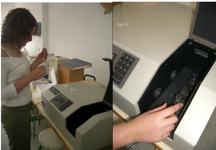
Lucrecia colocando un cultivo bacteriano en la cubeta del espectrofotómetro para medir su absorbancia.
