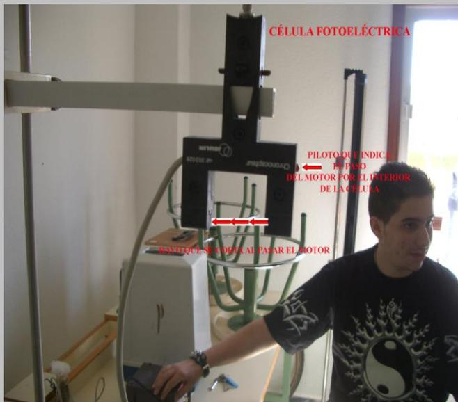
Las células fotoeléctricas se sitúan en la trayectoria de los motores 2 y 3 a los que hemos acoplado un palillo de longitud 2cm. Cuando el palillo pasa por la célula, corta el rayo de luz que va de un lado a otro de la U que forma la célula, quedando registrado este paso en el cronómetro digital. Material cedido por el CEO Luján Pérez.
