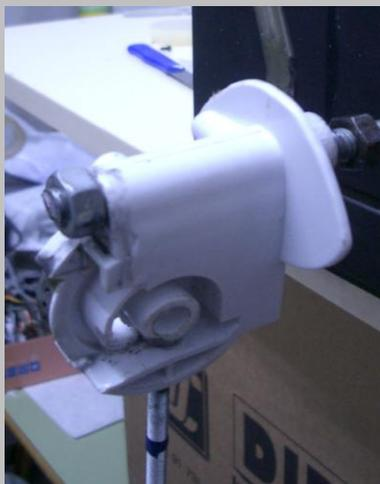
Conectada a la biela con un tornillo en su lateral, se mueve por acción del motor sobre la pieza 4. Esta pieza presenta un hueco horizontal que se inserta en una varilla roscada limitando así su movimiento. En la parte inferior y superior se le practican dos agujeros atornillando una varilla roscada vertical, inferior o superior según los planetas a estudio, en la que se colocarán los tubos eppendorf que contienen los microorganismos. Material reciclado de un ventilador estropeado.
