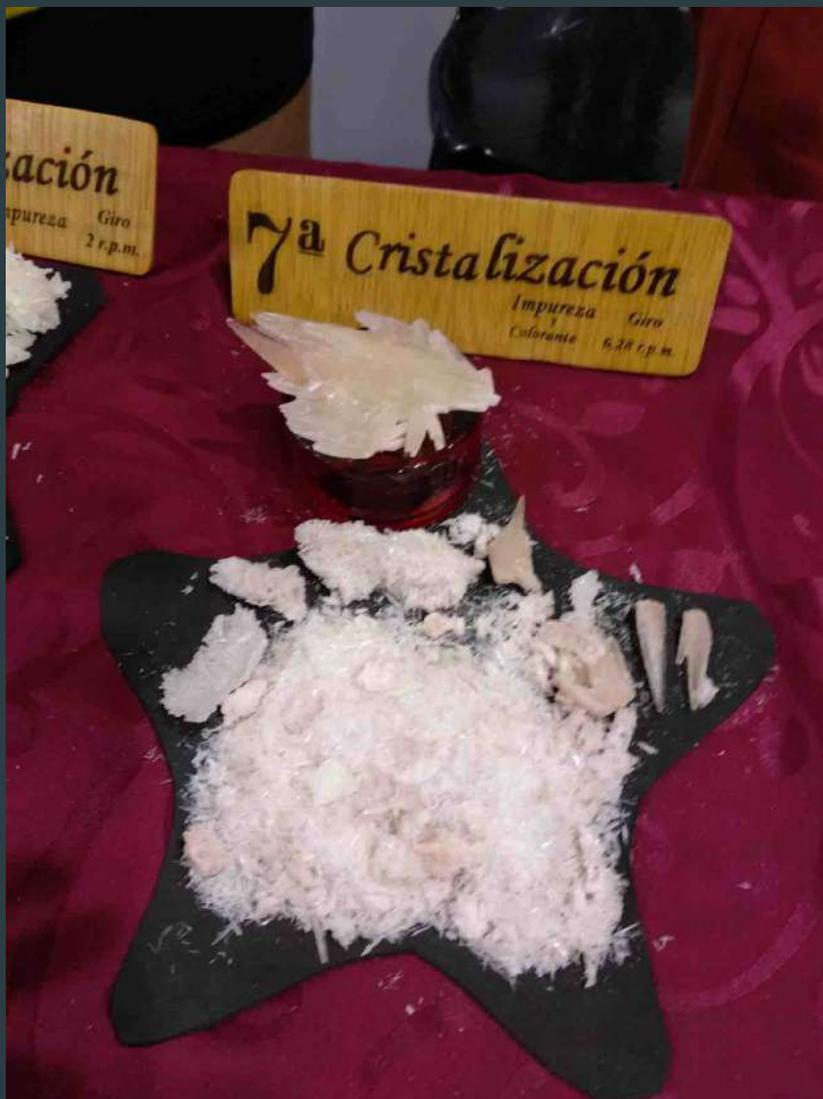
con impureza  $\text{FeSO}_4$ , y colorante rojo. Giro a 6,25rpm
