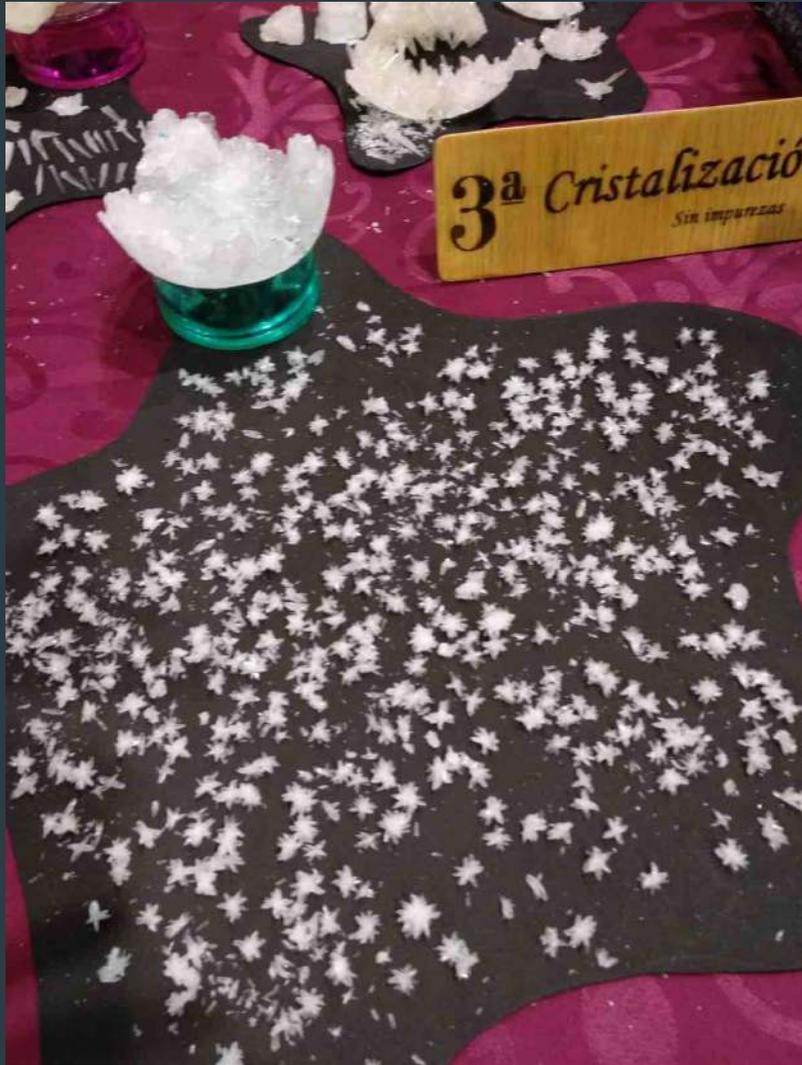
3ªCristalización:Una disolución dividida en dos recipientes, uno vertical y otro en el simulador. Girando a 1 revolución cada 5 minutos .
