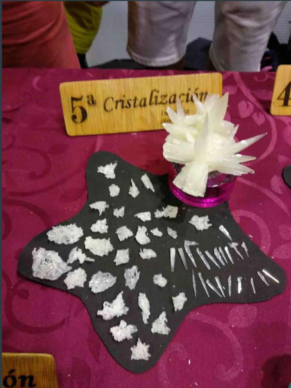
5ª cristalización con impureza  $\text{FeSO}_4$ . (repetición). Giro 0,1rpm
