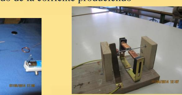
c) Para los generadores eléctricos hemos usado los mismos elementos que para el motor pero al revés, en vez de una fuente hemos conectado un led para que al girar las dinamos (Una de forma manual y otra por el viento producido por un secador de pelo sobre las aspas) se encendiera el led. Al hacer girar las bobinas cerca de los imanes se induce en éstas una corriente eléctrica que permite iluminar el led.
