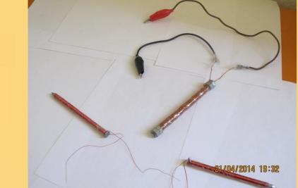
b) Para los motores eléctricos: barras de hierro, imanes e hilo de cobre que hemos enrollado sobre las barras sobre un eje cerca de los imanes con un sistema colector y una fuente de corriente continua. Al conectar la fuente de corriente las bobinas eléctricas se convierten en electroimanes que interaccionan con los imanes moviéndose sobre el rotor. Gracias al colector que va invirtiendo el sentido de la corriente produciendo atracciones y repulsiones alternas que hacen girar el motor.
