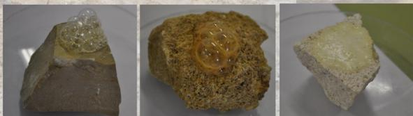
La efervescencia por reacción con ácido clorhídrico confirma la presencia de carbonato en las tres muestras
